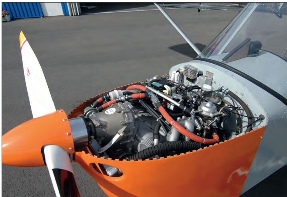
Die zweiteilige Cowling ist eines der wenigen Bauteile aus Kunststoff. In der Serienmaschine treibt der Jabiru 2200 einen Dreiblatt Propeller von DUC an; auf dessen Spinner sind Turbodeflektoren angebracht, die am Boden für zusätzliche Kühlluft sorgen.
