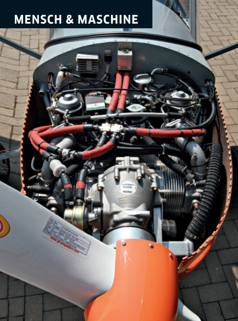
Zweierlei Motoren: Links Rotax 912, rechts Jabiru 2200 – beide sind zugelassen. Deflatoren am Prop versorgen den Direktantriebler auch im Stand mit Kühlluft
