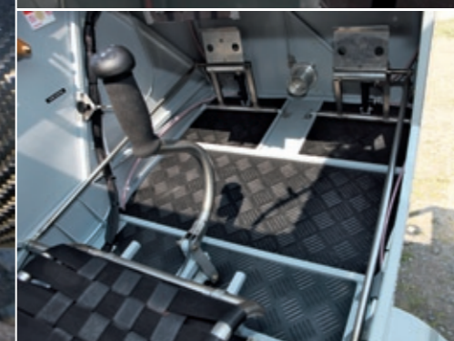
Alles offen: Verkleidungen würden das Design bloß stören. Auch die Gashebel-Mimik (rechts) ist frei zugänglich
