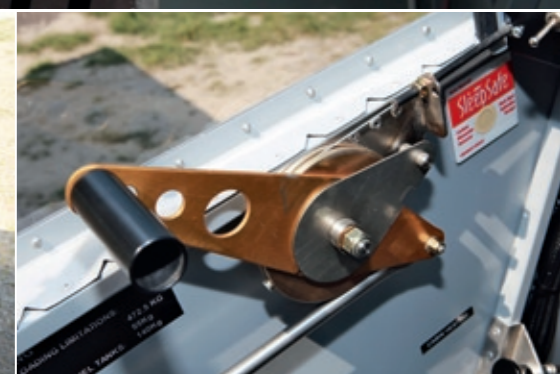
Alles offen: Verkleidungen würden das Design bloß stören. Auch die Gashebel-Mimik (rechts) ist frei zugänglich
