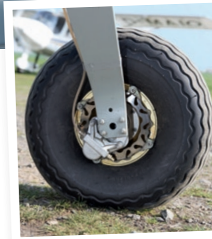
Groß und kräftig: 42-Zentimeter-Räder und hydraulische Scheibenbremsen von Marc-Ingegno
