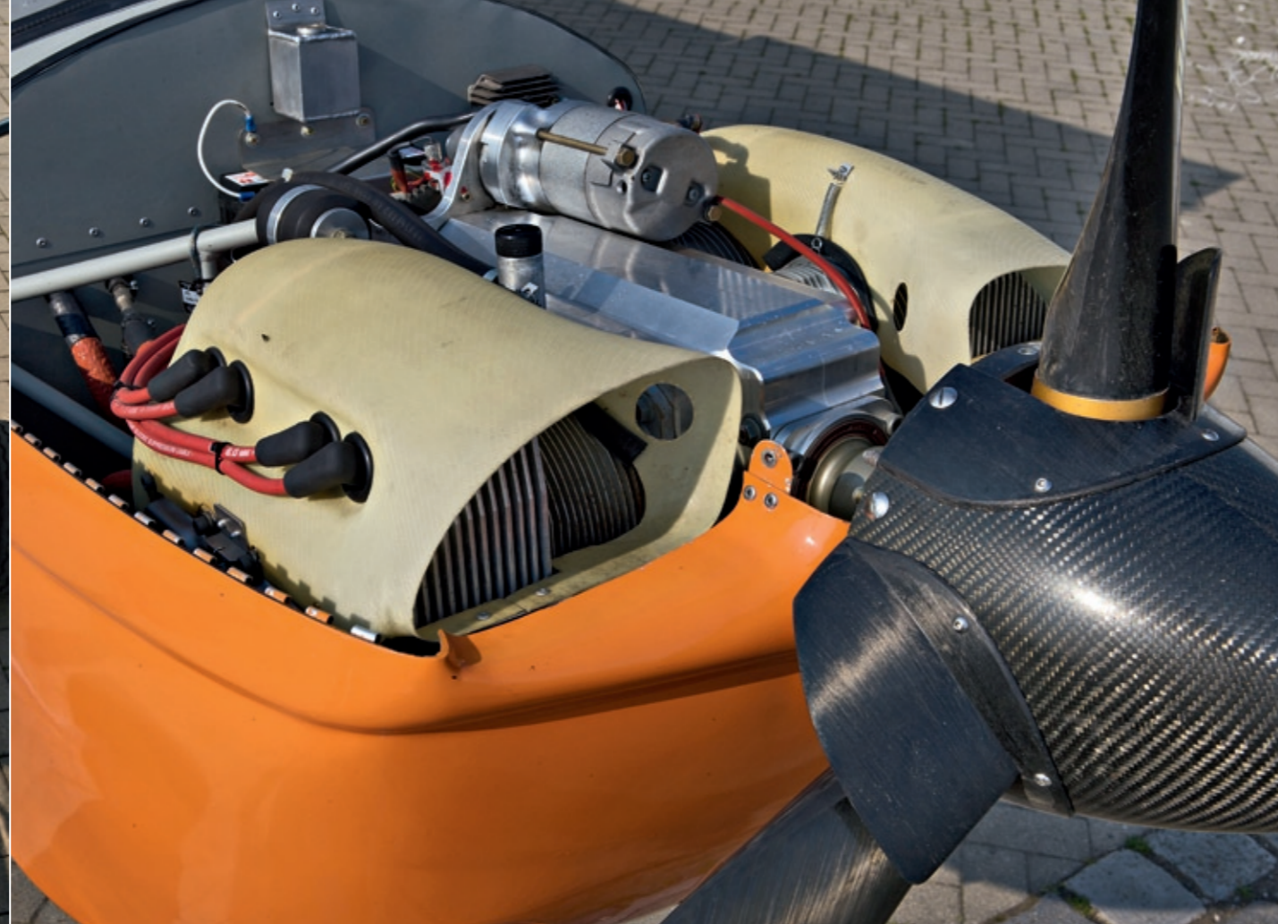
Zweierlei Motoren: Links Rotax 912, rechts Jabiru 2200 – beide sind zugelassen. Deflatoren am Prop versorgen den Direktantriebler auch im Stand mit Kühlluft
